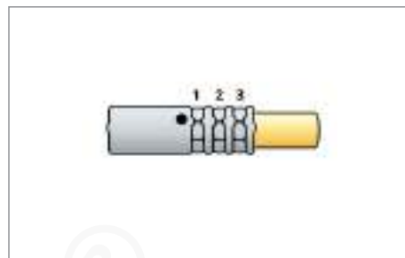
2.3 – Dalsze zaprasowania (od środka na zewnątrz)
